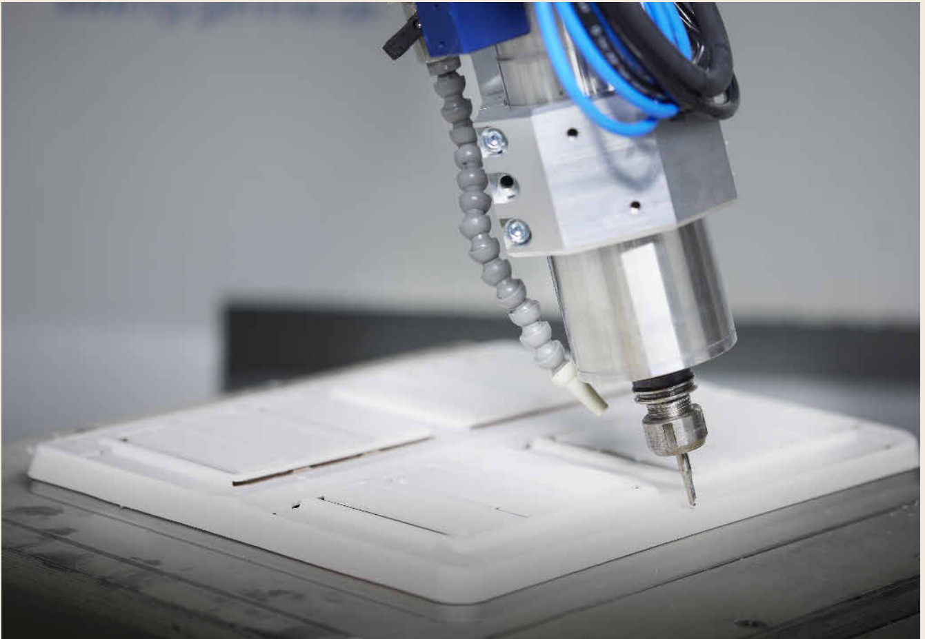
Bild 1: Schnell und schlank: Der grazile NC-Kopf hat sich nicht nur bei einfachen Fräsaufgaben, sondern auch beim Zerspanen enger Kavitäten bewährt. Foto: HG Grimme/Ralf Baumgarten
