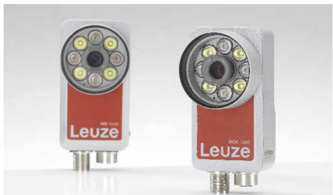
Der Funktionsumfang des IVS 1048i reicht je nach Modell von der Objekterkennung über Messaufgaben bis hin zur integrierten Barcodelesung. Foto: Leuze
