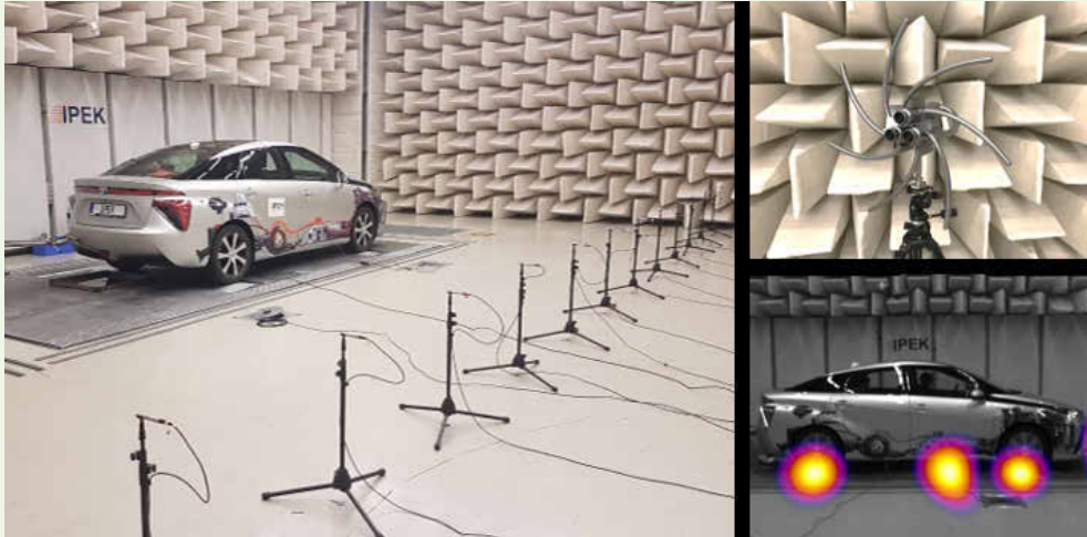
Bild 1: Versuchsaufbau für die Außengeräusch-Untersuchung eines Brennstoffzellenfahrzeuges auf dem IPEK-Akustikrollenprüfstand mit Mikrofonarray (links), akustischer Kamera (re. oben) sowie Software-Ausgabe der akustischen Kamera (re. unten) [2]. Foto: Verfasser
