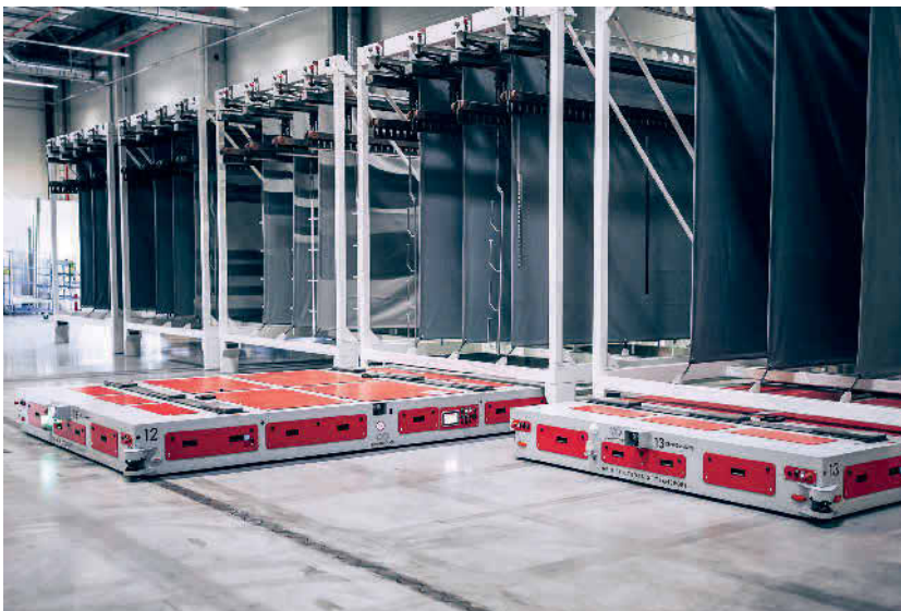
Die Transportroboter von ek robotics transportieren bei Warema Sonderlastträger mit einem Gewicht bis zu 4.500 kg. Foto: ek robotics
