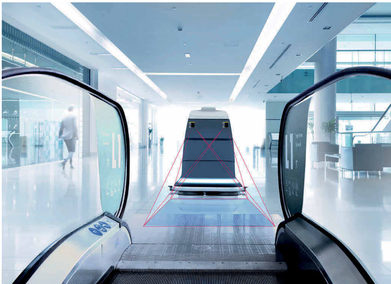
Bild 1: Mit der 3D-Kamera werden auch Hindernisse oberhalb der Scanfeldebene eines Sicherheitslaserscanners erfasst und Kollisionen vermieden. Foto: Sick
