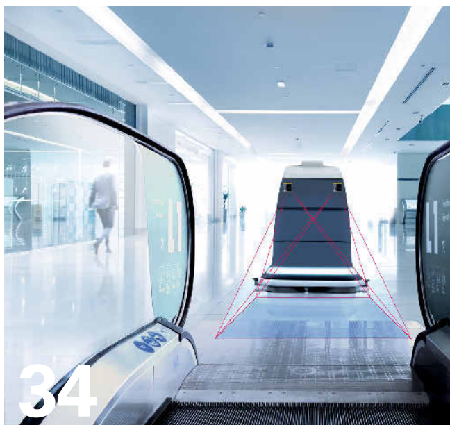
Industrielle Sicherheitstechnik — Mit der 3D-Kamera werden auch Hindernisse oberhalb der Scanfebene eines Sicherheitslaserscanners erfasst und Kollisionen vermieden. Foto: Sick
