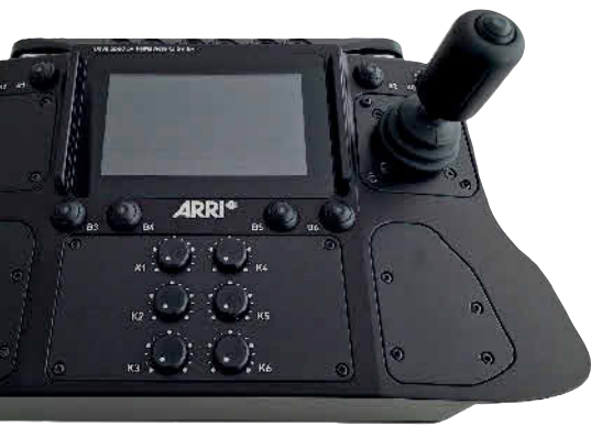
Bild 2: Mit dem Remote Control Panel RCP-1 lassen sich die Bewegungen der Stabilized Remote Heads exakt steuern. Foto: ARRI AG
