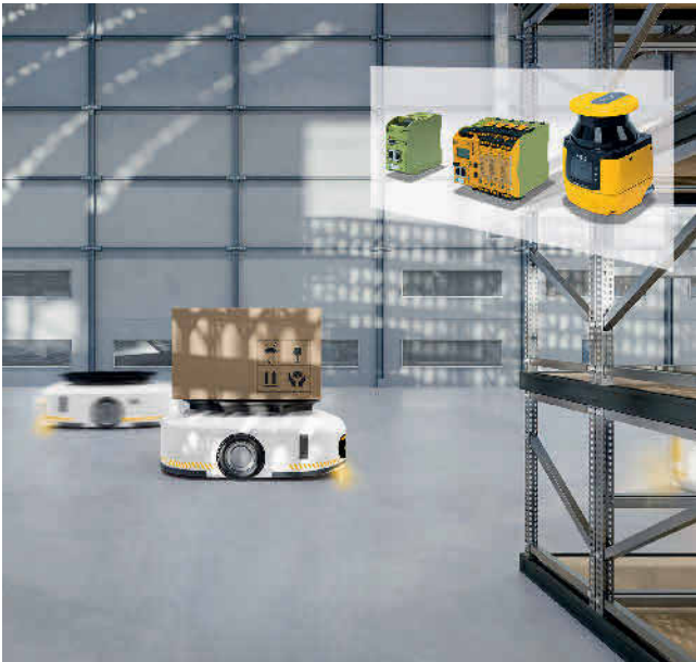
Die Sicherheitslösung aus der konfigurierbaren Kleinsteuerung, dem Sicherheits-Laserscanner und der Security Bridge sorgen bei autonomen mobilen Plattformen für Sicherheit.
