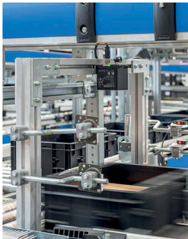
Die neue 3D-Kamera AM-T100: Sie ist Teil des IIoT-Demonstrators, mit dem Schmersal beispielhaft zeigt, wie sich das Industrielle Internet der Dinge umsetzen lässt. Foto: Schmersal
