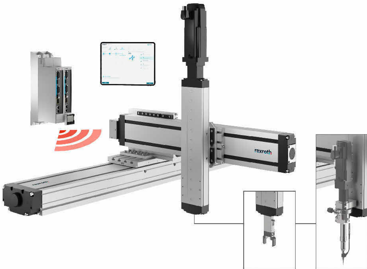
Bild 1: Die Smart Function Kits für Handhabungs- und Fügeaufgaben können als vorkonfigurierte Subsysteme bestellt und über das Web-HMI in wenigen Minuten in Betrieb genommen werden. Foto: Bosch Rexroth AG
