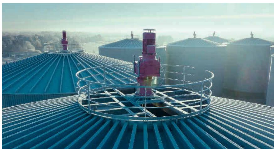
Bild 3: Die vorgenommenen Optimierungen an den Industriegetrieben erhöhen die Zuverlässigkeit und verlängern die Wartungsintervalle der Rührwerke. Foto: Nord Drivesystems
