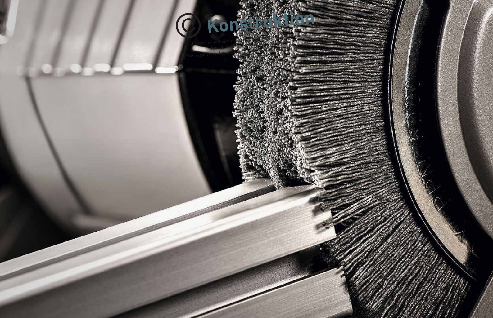
Bild 1: Kantenverrunden eines Aluminiumprofils mit einer technischen Bürste: Die Eintauchtiefe in das Werkstück muss exakt definiert sein und die abrasiven Filamente müssen sich elastisch an die Kanten und Konturen anlegen können. Foto: Kullen-Koti
